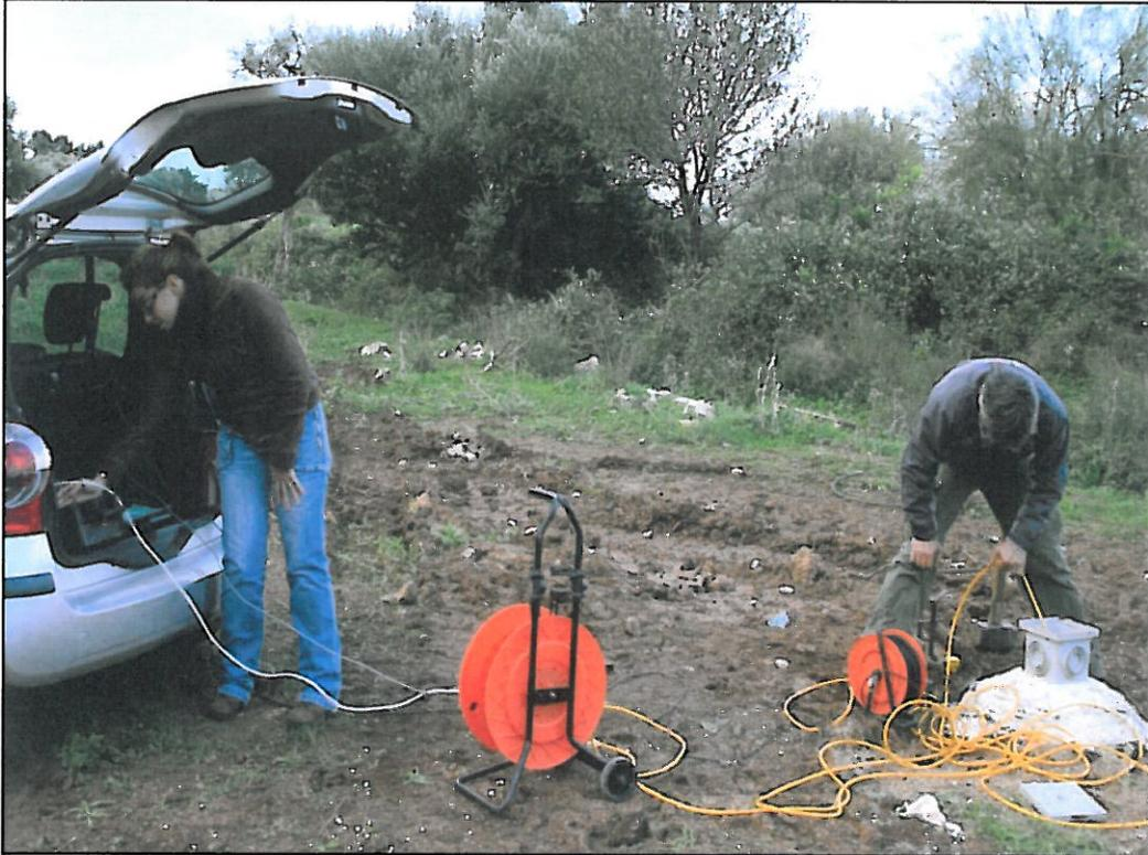
Acquisizione del sondaggio sismico DH-S2 in corrispondenza del sondaggio geognostico S2
