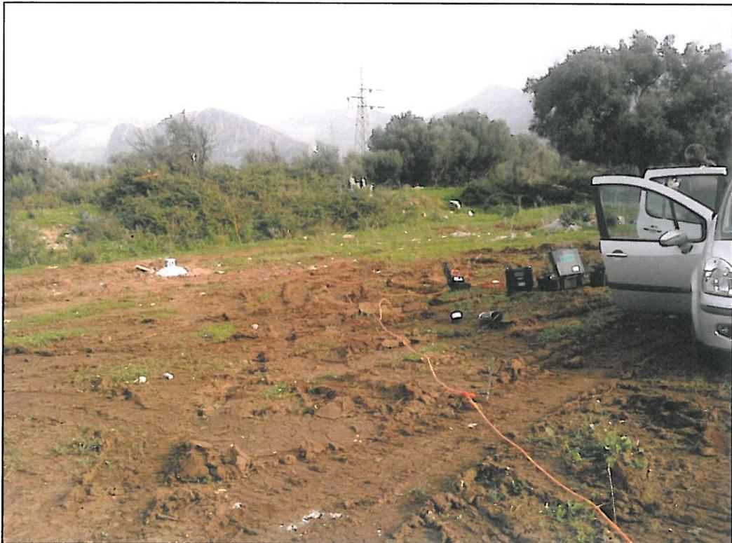
Acquisizione del profilo tomografico ERT2 in prossimità del sondaggio geognostico S2
