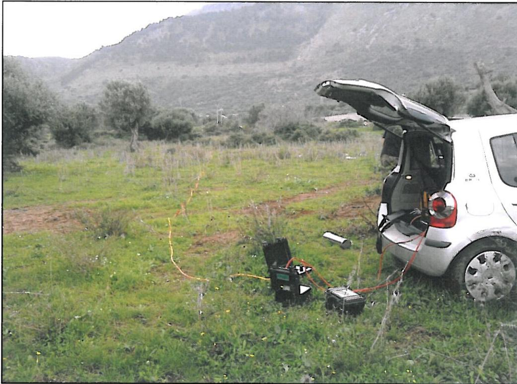
Acquisizione del profilo tomografico ERT1 in prossimità del sondaggio geognostico S6
