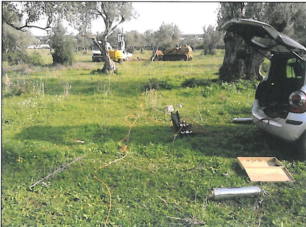
Acquisizione del profilo tomografico ERT4 in prossimità del sondaggio geonostico S5
